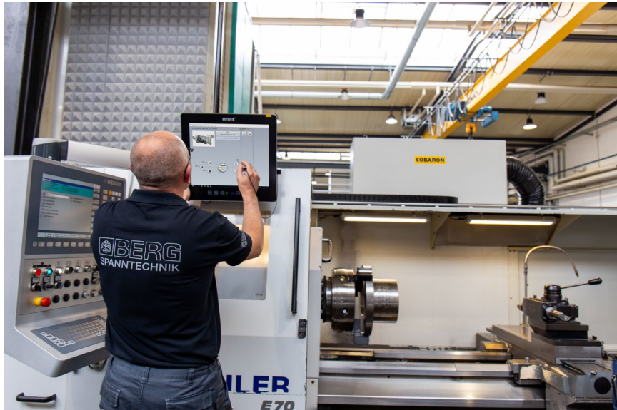
Bild 6: Im digitalen Einrichteblatt an den InfoPOINT Terminals sieht der Werker aller Informationen, die er für die Auftragsbearbeitung braucht.
