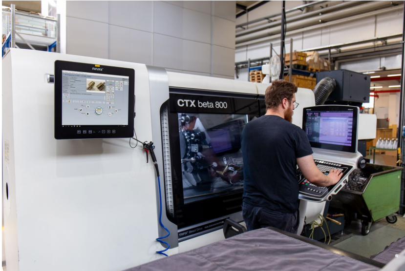
Bild 3: Der Maschinenpark von BERG Spanntechnik umfasst insgesamt 18 Dreh- bzw. Fräszentren und Schleifmaschinen. Die Datenvisualisierung erfolgt über COSCOM InfoPOINT VM direkt an den NC-Maschinen.
