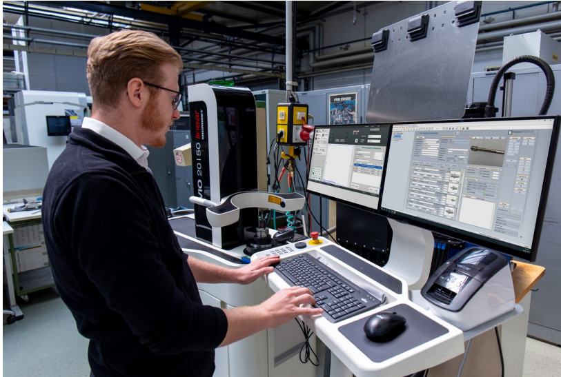
Bild 5: Auch das Werkzeugvoreinstellgerät von HAIMER tauscht Daten im Prozess eingebunden aus: vom Rüstzentrum mit dem zentralen COSCOM-Toolmanagement-Modul ToolDIRECTOR VM.
